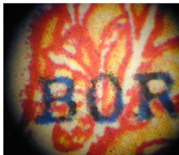
*Sous fort grossissement, le timbre faux montre des points de couleur, caractéristiques d'une impression par une imprimante jet d'encre*
